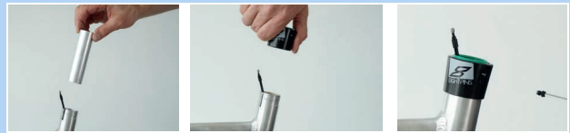
Abbildung 223: Gleitbuchse und Außenhülse einbauen
