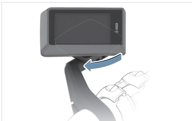
Abbildung 121: Bildschirm im Uhrzeigersinn drehen
