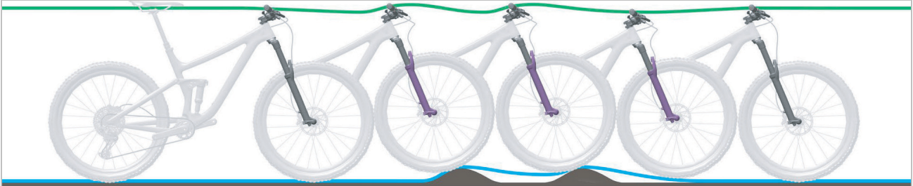
Abbildung 264: Zu langsames Ausfedern der Federgabel
