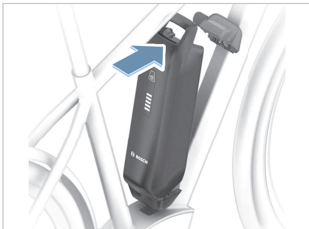
Abbildung 137: PowerPack Akku nach oben klappen
