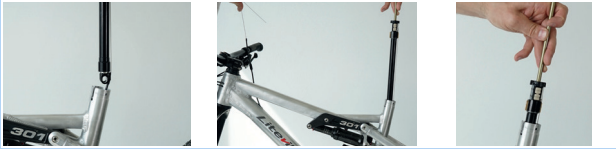
Abbildung 227: Kartusche Ventildeckel befestigen
