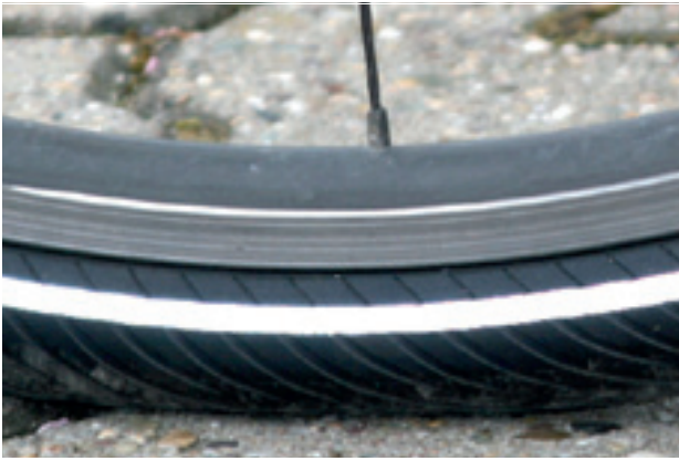
Abbildung 105: Korrekter Fülldruck. Der Reifen ist unter der Last des Körpergewichts kaum verformt
