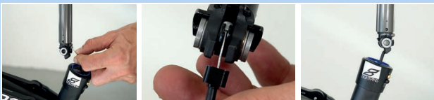
Abbildung 257: Sattelstütze aufhängen und einschieben
