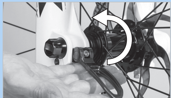
Abbildung 72: Schnellspannhebel in Pfeilrichtung drücken
