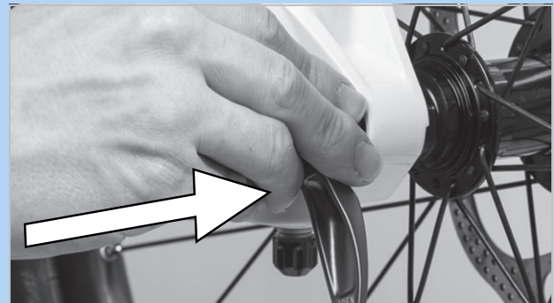
Abbildung 76: Schnellspanner in Pfeilrichtung einschieben
