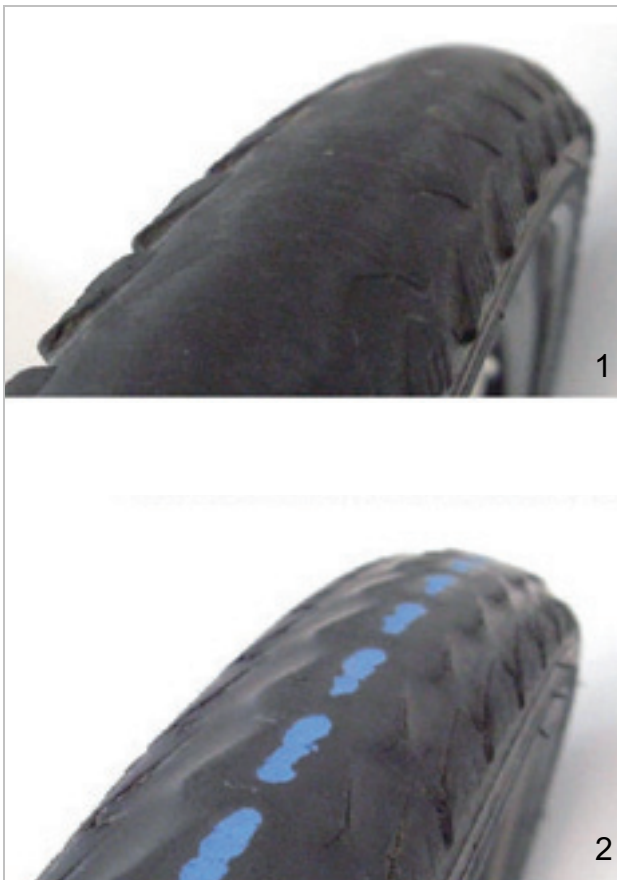
Abbildung 165: Reifen ohne Profil, der gewechselt werden kann (1) und Reifen mit durchscheinendem Pannenschutz (2), der gewechselt werden muss
