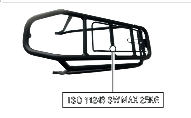
Abbildung 141: Auf dem Gepäckträger ist seine maximale Tragfähigkeit ausgewiesen
