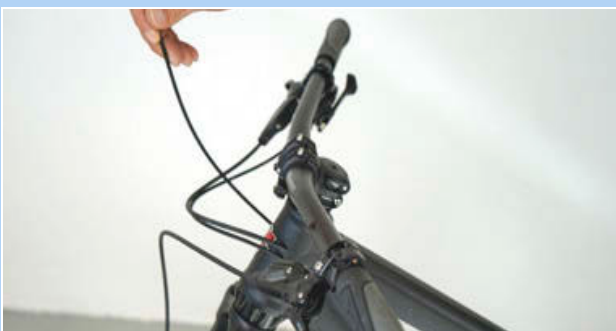
Illustration 260 : Accrocher le capuchon d'extrémité
