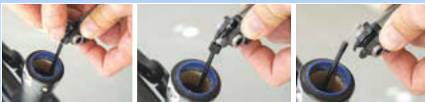
Illustration 242 : Retirer le câble Bowden
