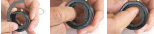
Illustration 214 : Insérer l'anneau de feutre
