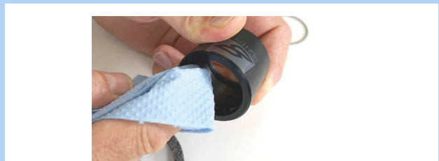
Illustration 213 : Nettoyer l'enveloppe extérieure
