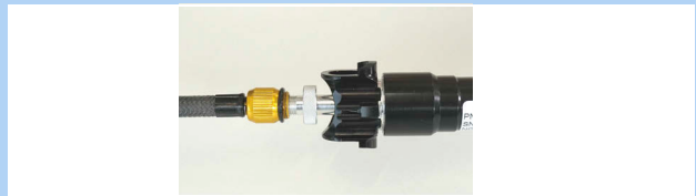
Illustration 219 : Pomper de l'air dans la cartouche
