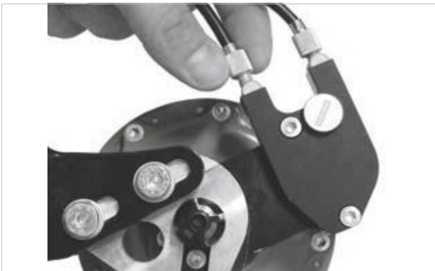
Illustration 195 : Sur les versions de moyeux ROHLOFF avec commande externe du changement de vitesse, le dispositif de réglage de la tension est situé sur le boîtier de câbles qui est placé sur le côté gauche
