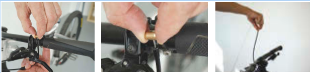
Illustration 240 : Détacher la télécommande
