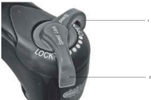
Illustration 158 : Dispositif de réglage de la compression Suntour avec les positions OPEN (1) et LOCK (2)
