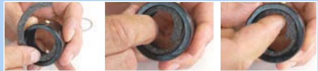
Illustration 249 : Insérer l'anneau de feutre
