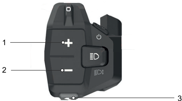
Abbildung 105: Lage Plus- (1), Minus (2), und Schiebehilfe- (3) Taster
