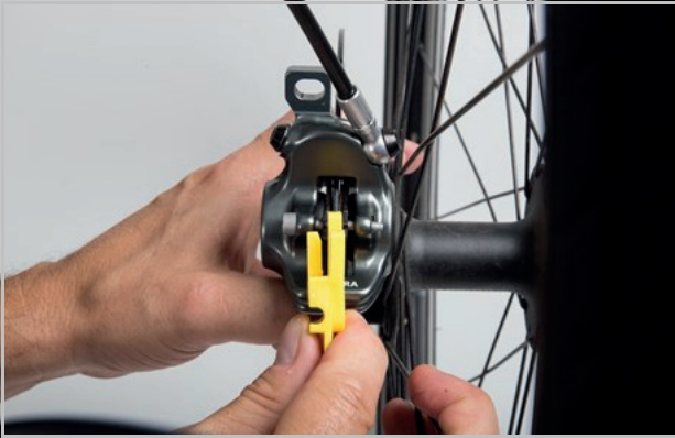
Abbildung 123: Bremsbelag im eingebauten Zustand mithilfe der Transportsicherung prüfen
