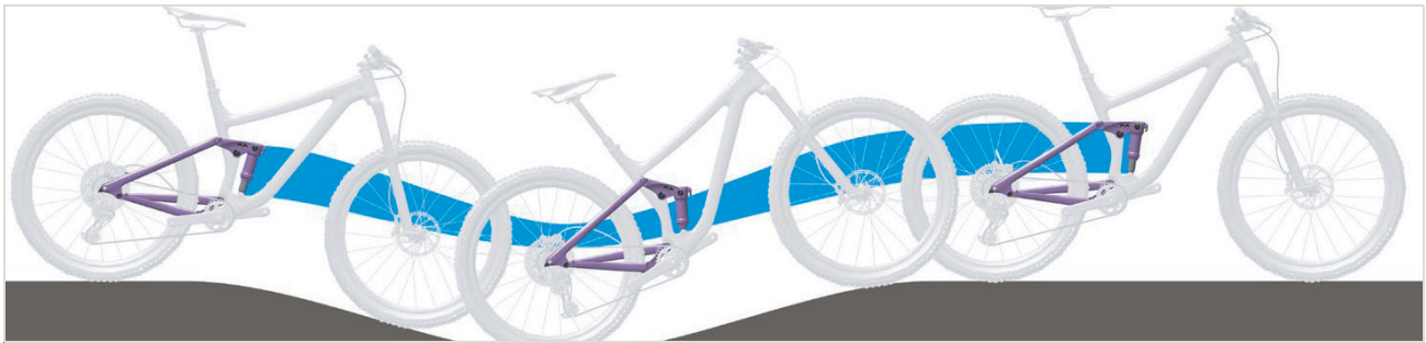
Abbildung 154: Zu weiche Federung des Hinterbau-Dämpfers am Berg
