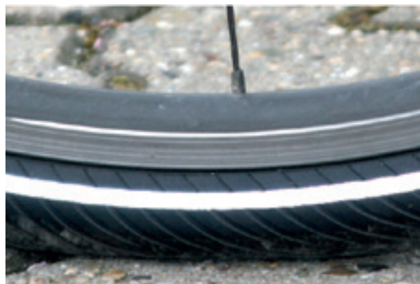
Abbildung 68: Korrekter Fülldruck. Der Reifen ist unter der Last des Körpergewichts kaum verformt
