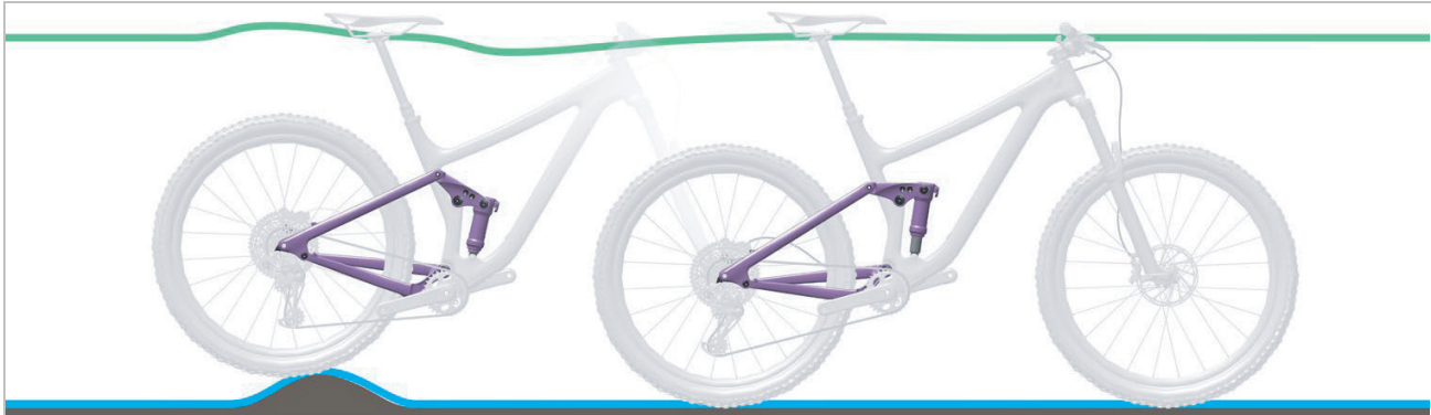
Abbildung 100: Optimales Fahrverhalten des Hinterbau-Dämpfers bei Unebenheiten
