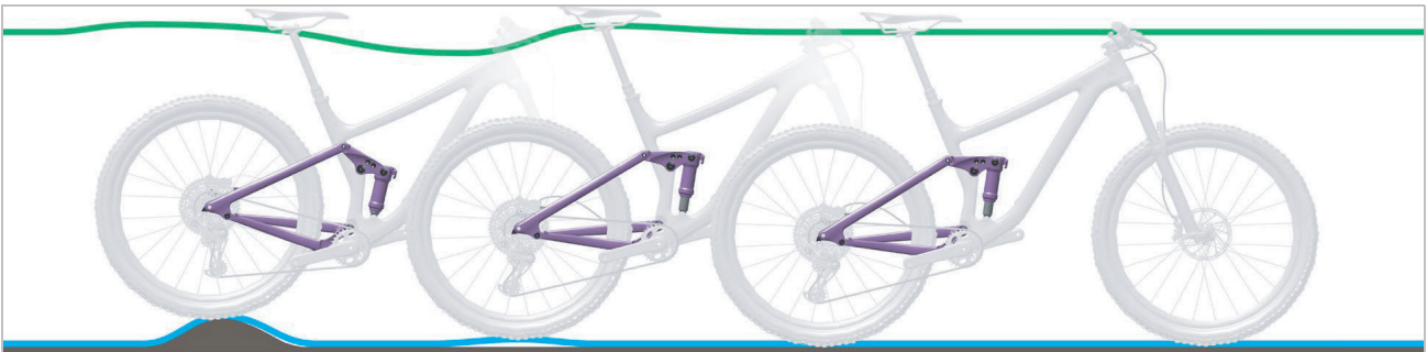
Abbildung 150: Zu schnelles Ausfedern des Hinterbau-Dämpfers
