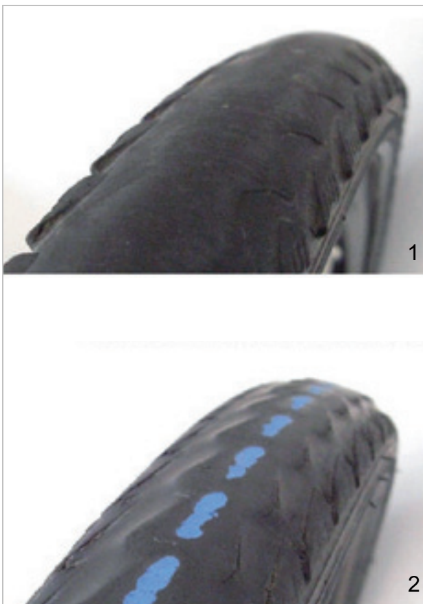
Abbildung 121: Reifen ohne Profil, der gewechselt werden kann (1) und Reifen mit durchscheinendem Pannenschutz (2), der gewechselt werden muss
