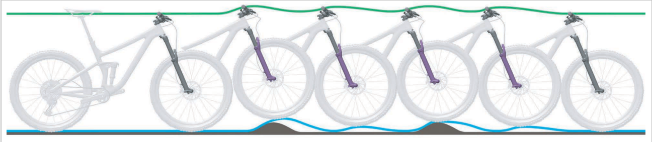
Abbildung 144: Zu schnelles Ausfedern der Federgabel
