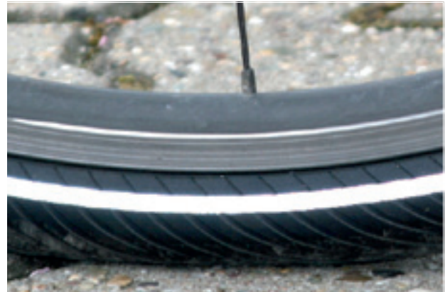
Abbildung 79: Korrekter Fülldruck. Der Reifen ist unter der Last des Körpergewichts kaum verformt
