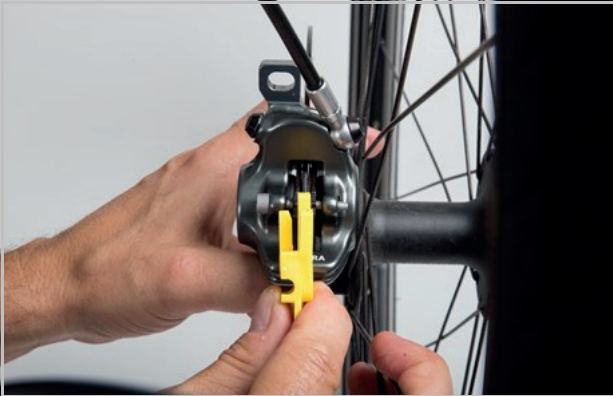
Abbildung 126: Bremsbelag im eingebauten Zustand mithilfe der Transportsicherung prüfen
