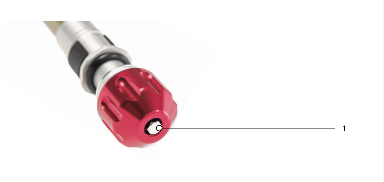
Abbildung 150: Beispiel SR SUNTOUR Zugstufen-Einsteller (Federgabel) (1)
