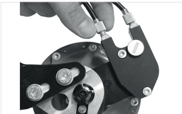
Abbildung 141: ROHLOFF-Naben Versionen mit externer Schaltansteuerung haben die Zugeinsteller an der Seilbox, die sich auf der linken Seite befindet
