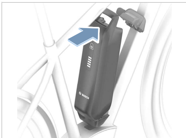
Afbeelding 137: PowerPack accu omhoog klappen
