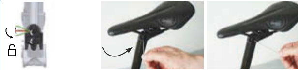
Afbeelding 201: Bediening hoogteverstelling in stand "geopend" zetten
