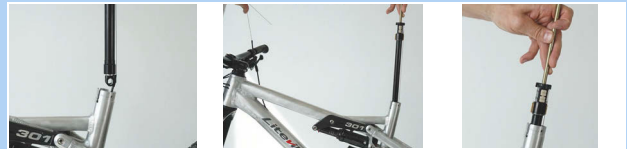
Afbeelding 229: Ventioldop van de patroon aanbrengen
