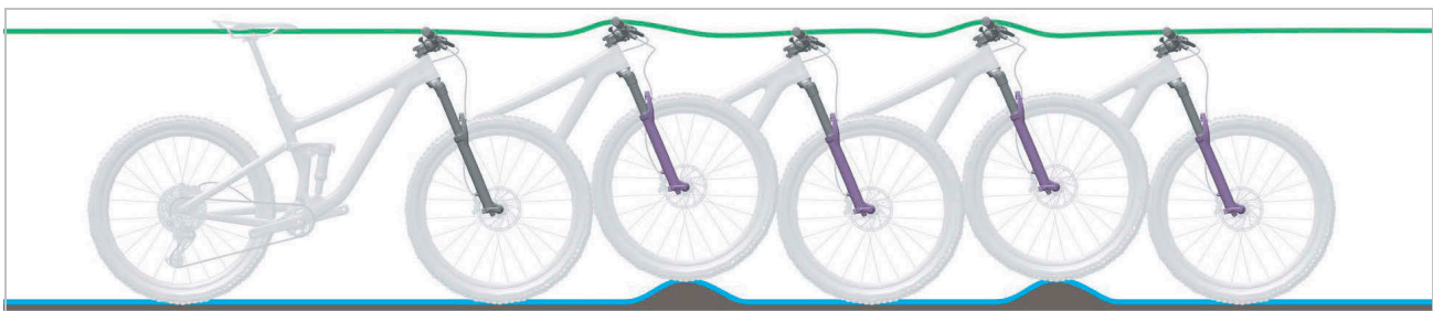
Afbeelding 13: Optimaal rijgedrag van de verende voorvork
