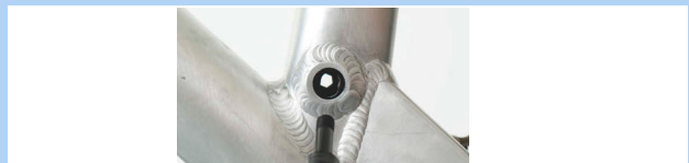
Afbeelding 230: Ventioldop van de patroon aanbrengen
