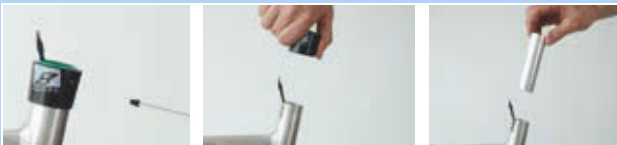
Afbeelding 209: Buitenhuls en glijbus demonteren
