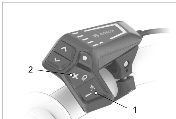
Afbeelding 151: Locatie plus-toets en min-toets
