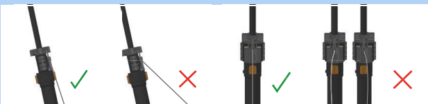
Afbeelding 228: Correcte en verkeerde bowdenkabel
