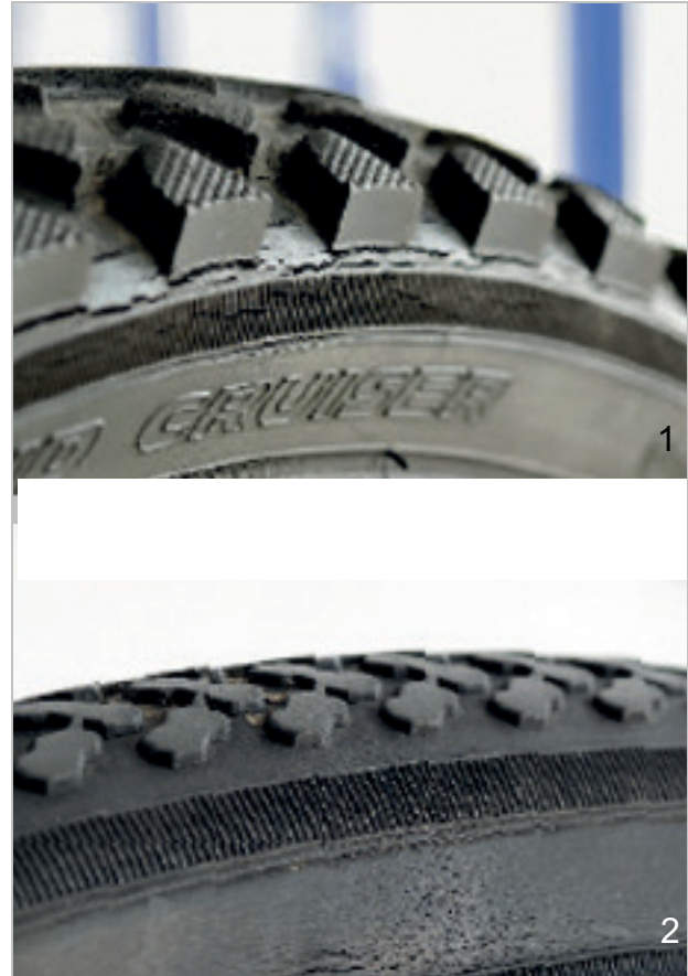
Abbildung 142: Beispiele für Ermüdungsrisse (1) und Alterungsrisse (2)
