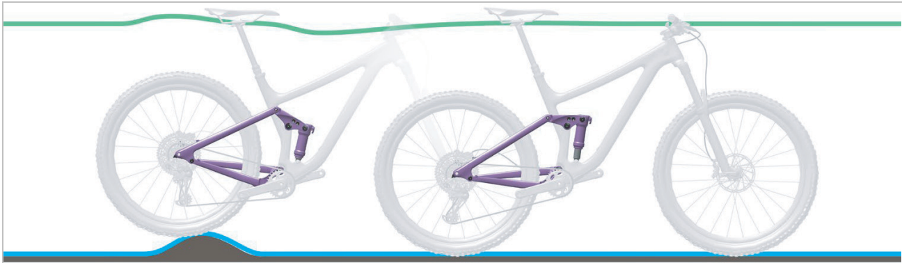
Abbildung 100: Optimales Fahrverhalten des Hinterbau-Dämpfers bei Unebenheiten
