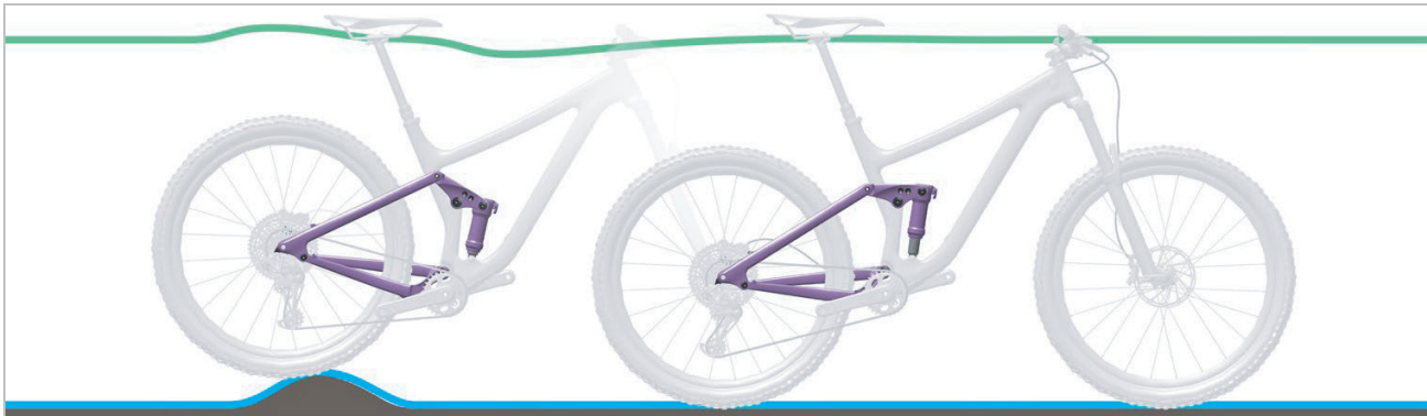
Abbildung 120: Optimales Fahrverhalten des Hinterbau-Dämpfers bei Unebenheiten
