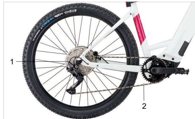
Abbildung 46: Schema Kettenantrieb mit Kettenschaltung
